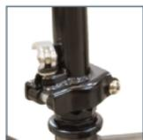
La abrazadera de apertura rápida ③ en la base de la columna de dirección ahora debe estar mirando hacia adelante. La abrazadera tiene un sujetador de seguridad adicional para evitar que colapse durante el uso. Suelte la palanca y gírela hacia abajo
