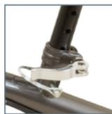
Réglez la hauteur de la plateforme repose-genou en tirant le levier de la pince ⑤ et en retirant la goupille du poteau ⑥. Cela vous permettra de faire monter et descendre la plateforme et de l'ajuster à la hauteur désirée. Une fois en place, réinsérez la goupille du poteau et poussez vers le bas pour verrouiller la pince du poteau.
