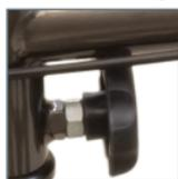
Inserte la cerradura de seguridad de la dirección de la estructura de la columna de dirección ⑧. Apriete la perilla con firmeza hasta que no se vea ninguno de los conductos. Esto es para evitar que el eje no se exceda en rotación. No hacerlo puede provocar que se voltee o detenga bruscamente, y causar graves lesiones. El movimiento del eje o del manubrio no debe ser más de aproximadamente 45 grados a la izquierda y derecha.
