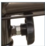
Insérez le verrou de sécurité de la colonne de direction ⑧ au-dessous du cadre sur la colonne de direction. Serrez fermement le bouton jusqu'à ce qu'aucun des fils ne paraisse. Cela permet d'empêcher l'axe de tourner de façon excessive. Ne pas le faire peut entraîner le basculement ou un arrêt brusque provoquant de graves blessures. Le mouvement de l'essieu ou du guidon ne doit pas être de plus d'environ 45 degrés vers la gauche ou la droite.
