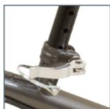
Ajuste la altura de la plataforma de rodilla jalando la palanca de la abrazadera ⑤ posterior y retirando el sujetador posterior ⑥. Esto le permitirá subir o bajar la plataforma y ajustar la altura deseada. Una vez en su lugar, vuelva a insertar el sujetador posterior y empuje hacia abajo para asegurar la abrazadera posterior.
